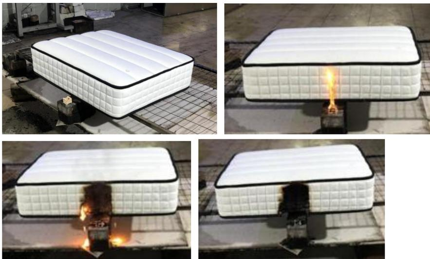
编号为 GMLFH017 的沙发样品在试验前、引燃后 15s、引燃后 90s、灭火后的照片，该样品在点火后 2min 后熄灭，无燃烧或阴燃，判定为未引燃，通过木垛引燃试验。
