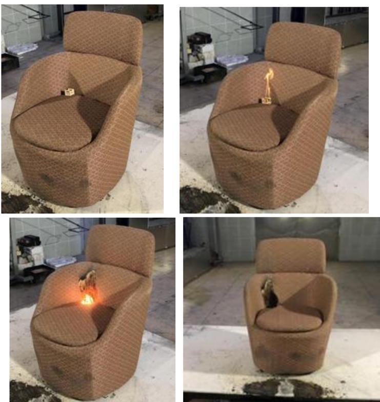
根据验证试验作业指导书，若 60min 内未检查到样品没有明火燃烧或增强性阴燃，则在样品其他满足要求的部位上重新测试。如果样品仍未发生无阴燃或明火燃烧，记录该试验为未引燃。以床垫和沙发为例，通过木垛引燃试验的软体家具示例如下：
